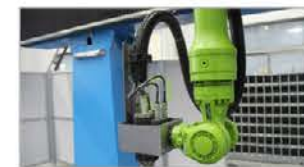
커팅 헤드 충돌 방지 시스템 Anti-collision protection system for cutting head
